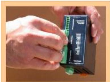
Nehmen Sie das Modul von der Hutschiene. Entfernen Sie alle Verbindungsstecker, d.h. die Buskabel an der Oberseite des Moduls sowie die CombiCon-Stecker an der Vorder- und Unterseite des Moduls.
