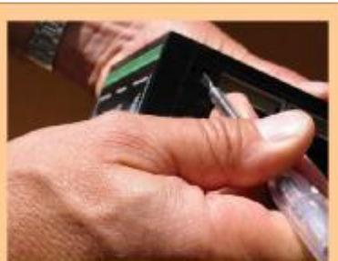
Entfernen Sie die Schrauben an der Ober- und Unterseite des Moduls. Öffnen Sie mit einem Schraubendreher oder ähnlichem Werkzeug die Halterungslaschen neben den Verschraubungen.
