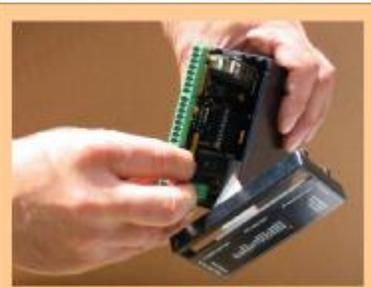
Entfernen Sie vorsichtig die Modulabdeckung. Achtung! Die LED-Anzeigen sind fest mit dem Deckel verbunden. Ziehen Sie dann langsam die Hauptplatine heraus.
